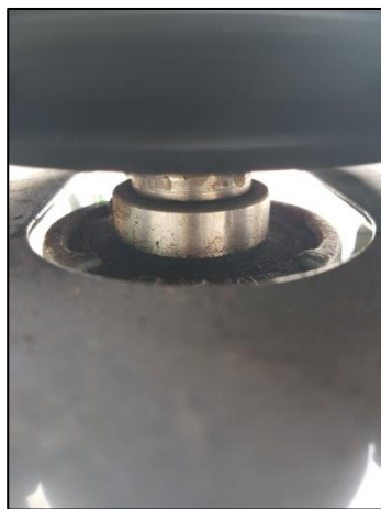
Bild 7: Klemmring am Stehlager öffnen
