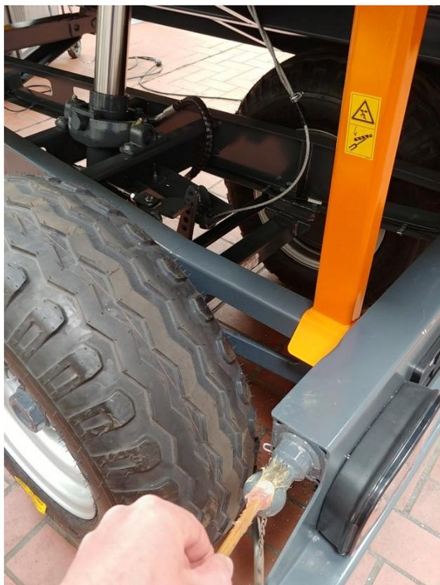
Abbildung 24: Kippmechanik schmieren
