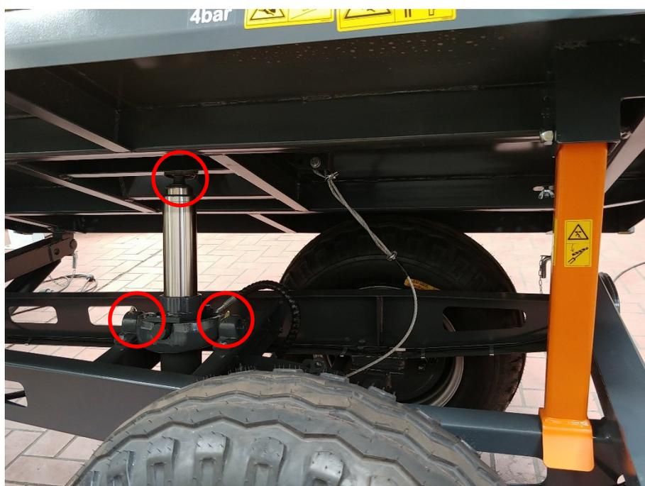
Abbildung 27: Zylinder schmieren
