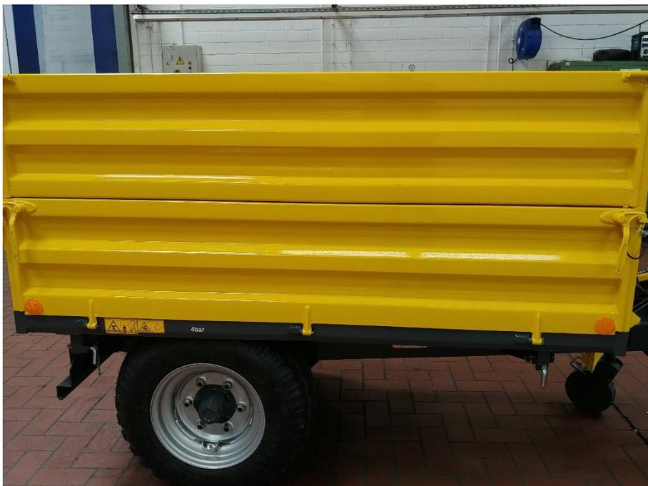
Abbildung 3: Bordwand links, Rückstrahler
