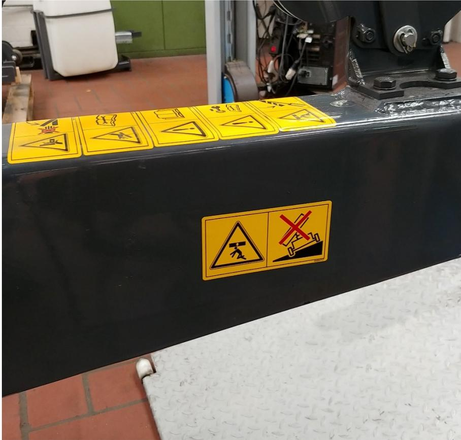
Abbildung 8: Sicherheitsaufkleber Deichsel rechts
