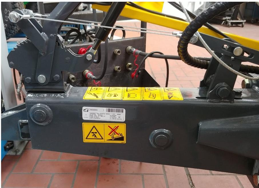
Abbildung 7: Sicherheitsaufkleber und Typenschild , Deichsel links
