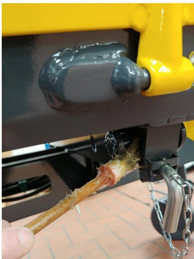
Abbildung 25: Kippmechanik schmieren
