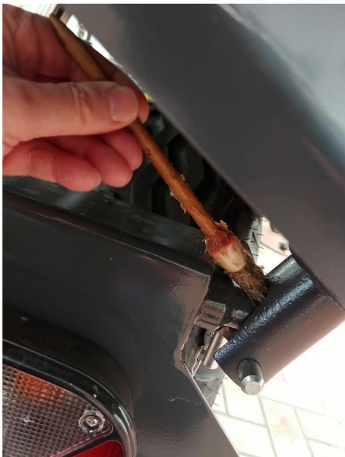
Abbildung 26: Kippmechanik schmieren
