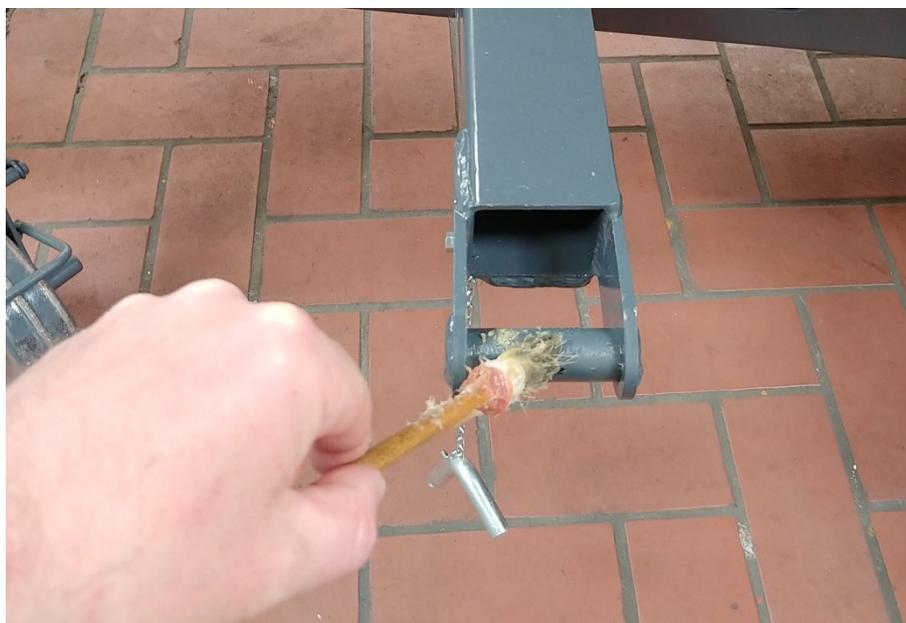
Abbildung 23: Kippmechanik schmieren
