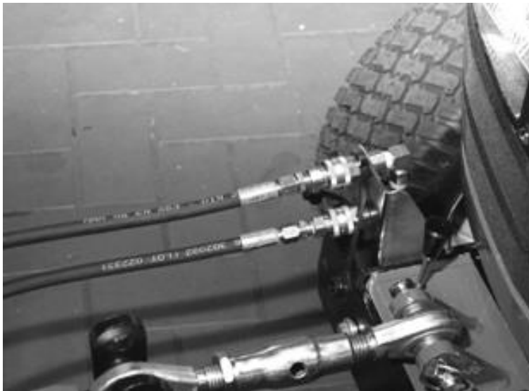
Bild 9: Anschluß der Hydraulikleitungen an die Schlepperhydraulik
