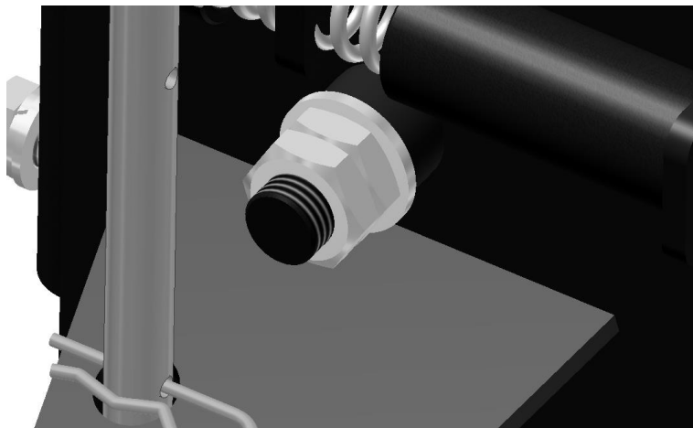
Bild 18: Pendelachse des Räumschildes
