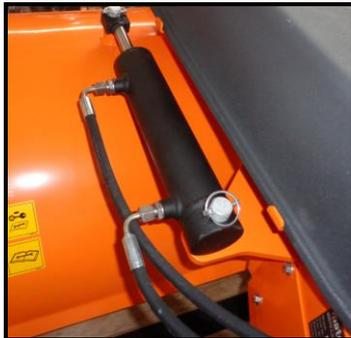
Bild 9: Schwenkzylinder
