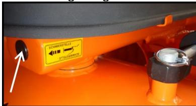
Bild 20: Schwenklager
