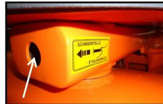
Bild 21: Schwenklager
