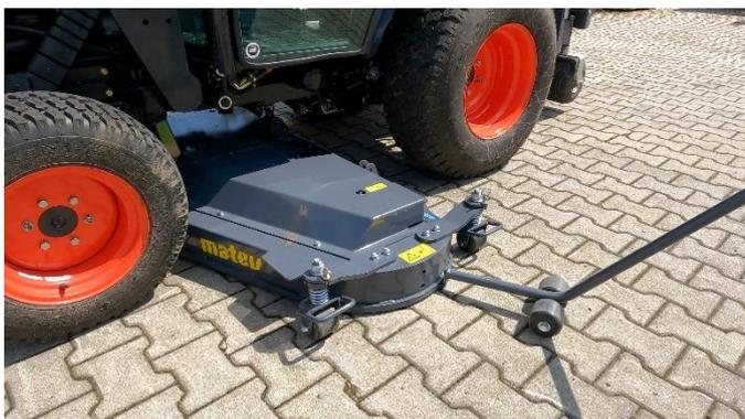
Abbildung 29 : Mähwerk seitlich unter den Traktor schieben
