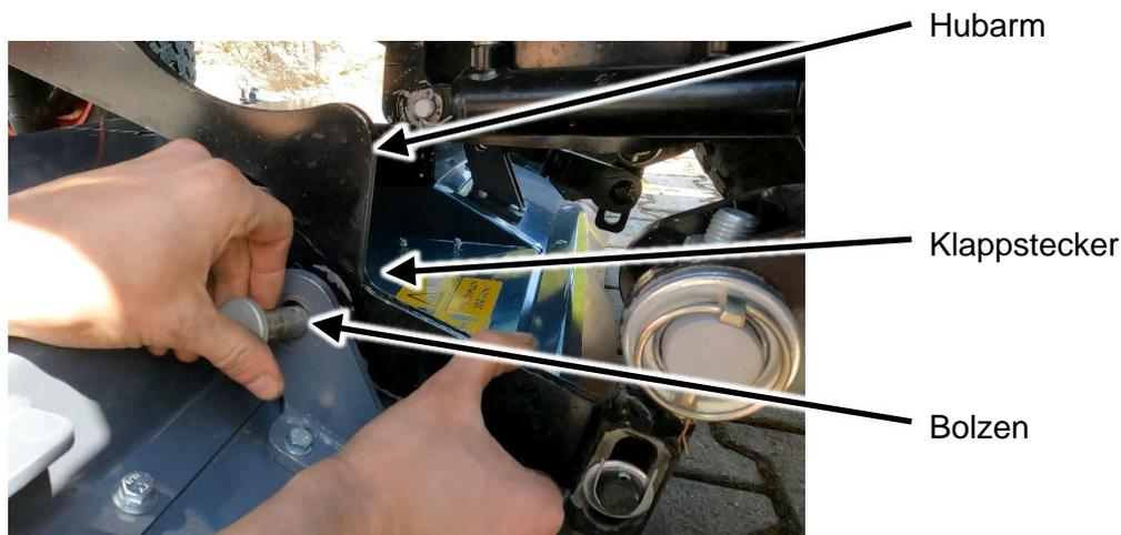
Abbildung 31 : Hubarm mit Mähwerk verbinden
