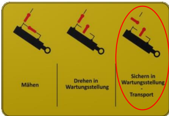
Abbildung 36: Pos. Der Absperrhähne „Sicherung in Wartungsstellung“
